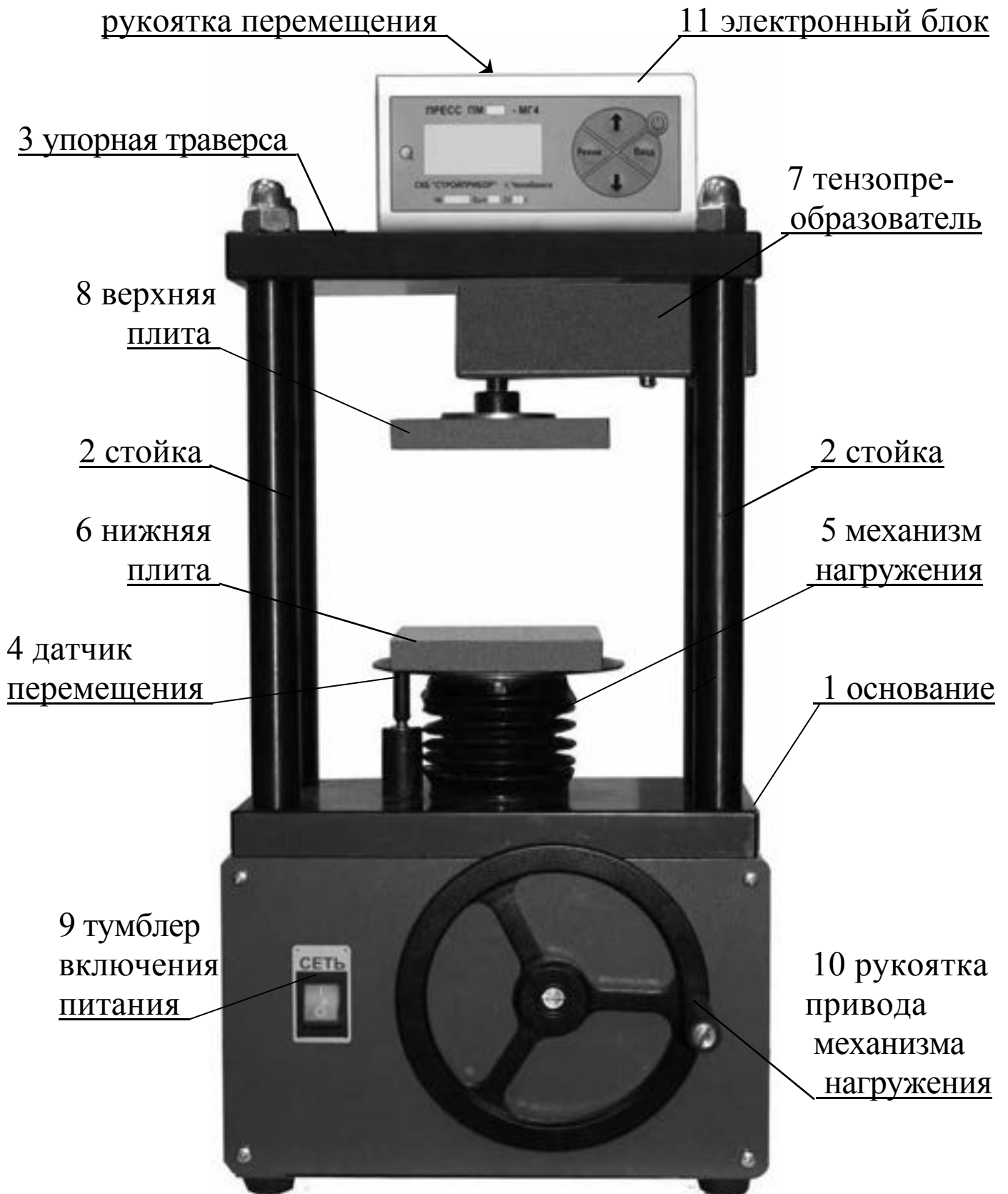
Рисунок 1.4.1 - Общий вид пресса ПМ-МГ4
